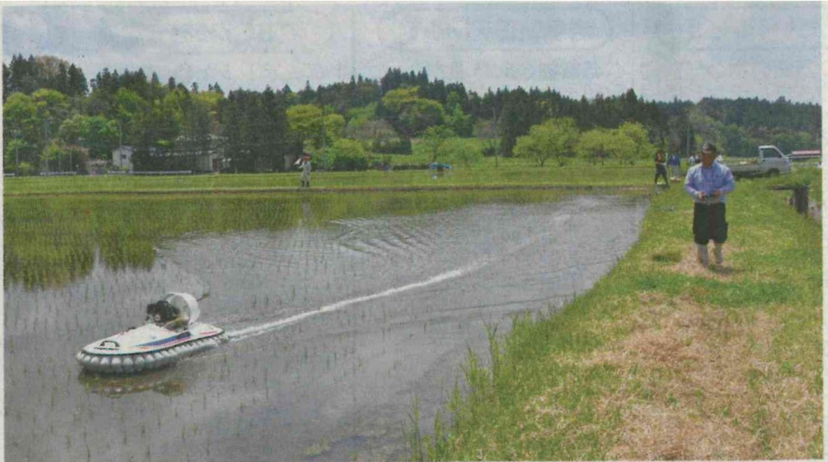
おくたま農産が試験的に取り組む無線操縦の ホーバークラフトによる除草剤散布
